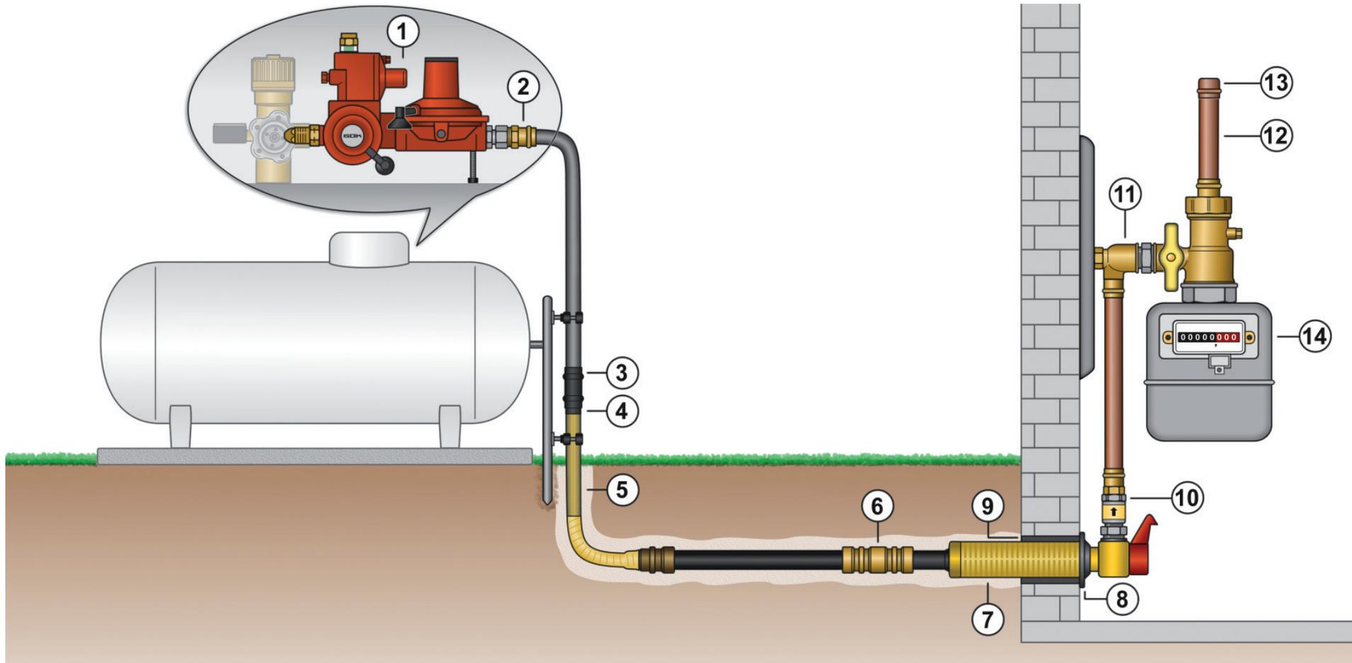
① Behälterregler-Kombination PS 25 bar - POL x ÜM 3/4 KN
